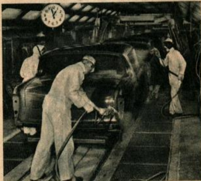
12 h. 58. Application de la première couleur (ver foncé). L'arceau visible à l'arrière-plan est une machine automatique de peinture par pulvérisation.
