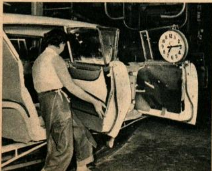
19 h. 14. Montage des panneaux de portes. La carrosserie roule sur un cadre à roulettes et se déplace continuellement au cours du travail.
