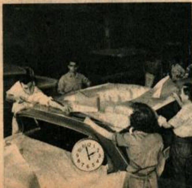
13 h. 58. Masquage des surfaces pour application de la deuxième couleur (vert clair). Cette opération est maintenant très importante, depuis que les peintures en deux tons sont à la mode.
