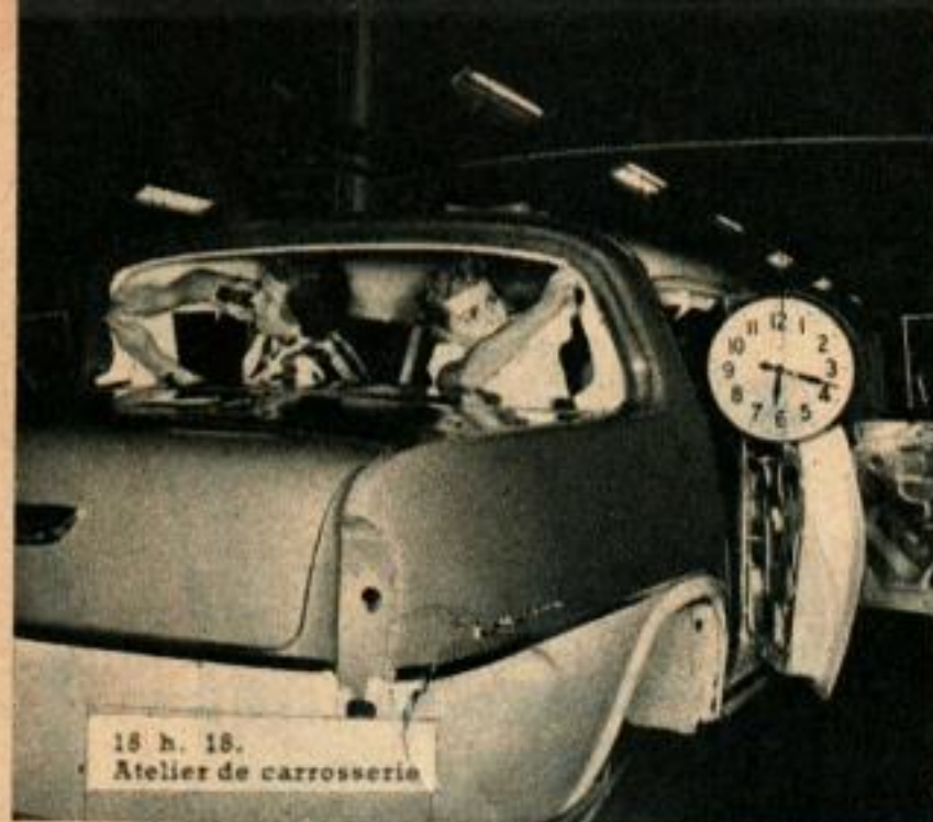
18 h. 18. La garniture intérieure est en cours. Les ouvrières ajustent la doublure du toit tandis que la voiture circule sur la chaîne.
