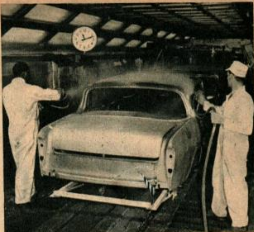
11 h. 11. Application de la couche d'apprêt. Les surfaces d'accès difficile sont traitées par des peintres les grandes surfaces sont peintes par des machines.
