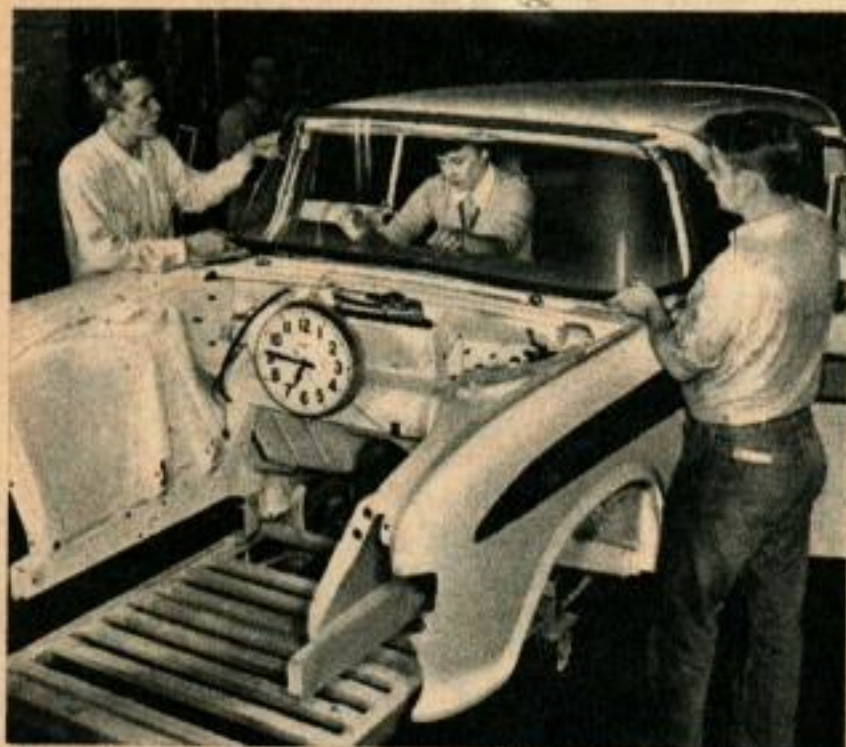
18 h. 46. Installation du pare-brise. L'ouvrière qui se trouve à l'intérieur de la voiture tire sur deux cordelettes pour soulever la lèvre du joint sur le bourrelet métallique.
