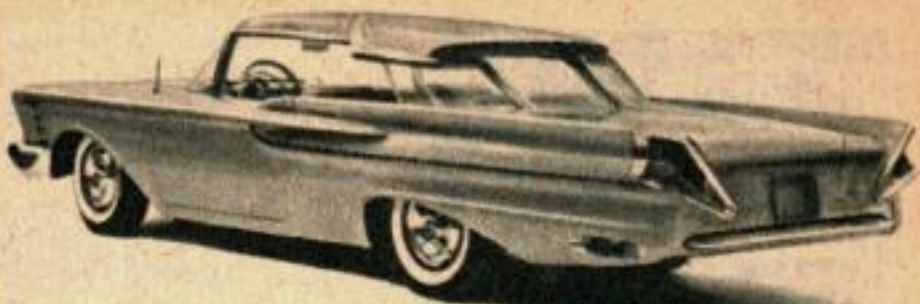
La MERCURY Turnpike Cruiser (Le Croiseur d'Autostrade) n'est haute que de 1 m 35. C'est une voiture à quatre places. Une partie du toit s'ouvre en même temps que les portes. Les lanternes arrière sont encastrées sous le rebord du toit au-dessus des fenêtres latérales enveloppantes.
