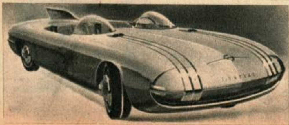
La PONTIAC Club de Mer, à gauche, est un exemple de carrosserie sport. C'est une deux places munie d'un petit alleron de queue pour accroître la stabilité aux grandes vitesses, disent les carrossiers. L'élément avant du capot pivote, pour dégager les phares, lorsqu'on appuie sur un contact.
