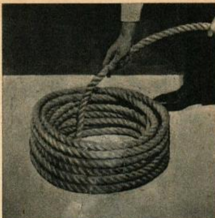
2. Déroulez une corde neuve torsadée à droite dans le sens contraire à celui des aiguilles d'une montre, déroulez une corde torsadée à gauche dans le sens des aiguilles d'une montre.
