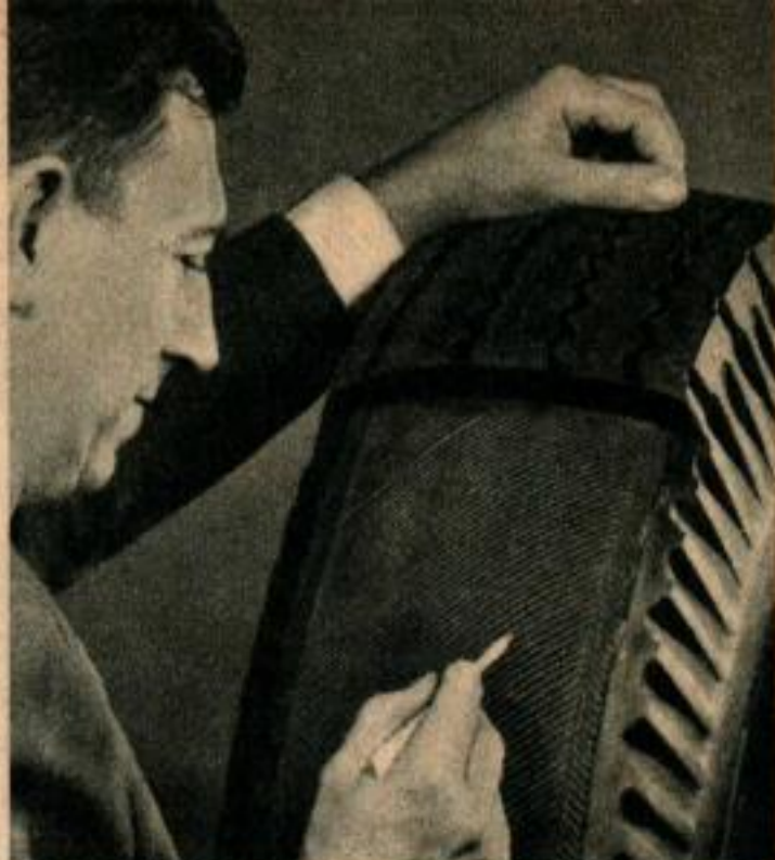
Un ingénieur du caoutchouc montre la trame des fils métalliques sous le chemin de roulement.
