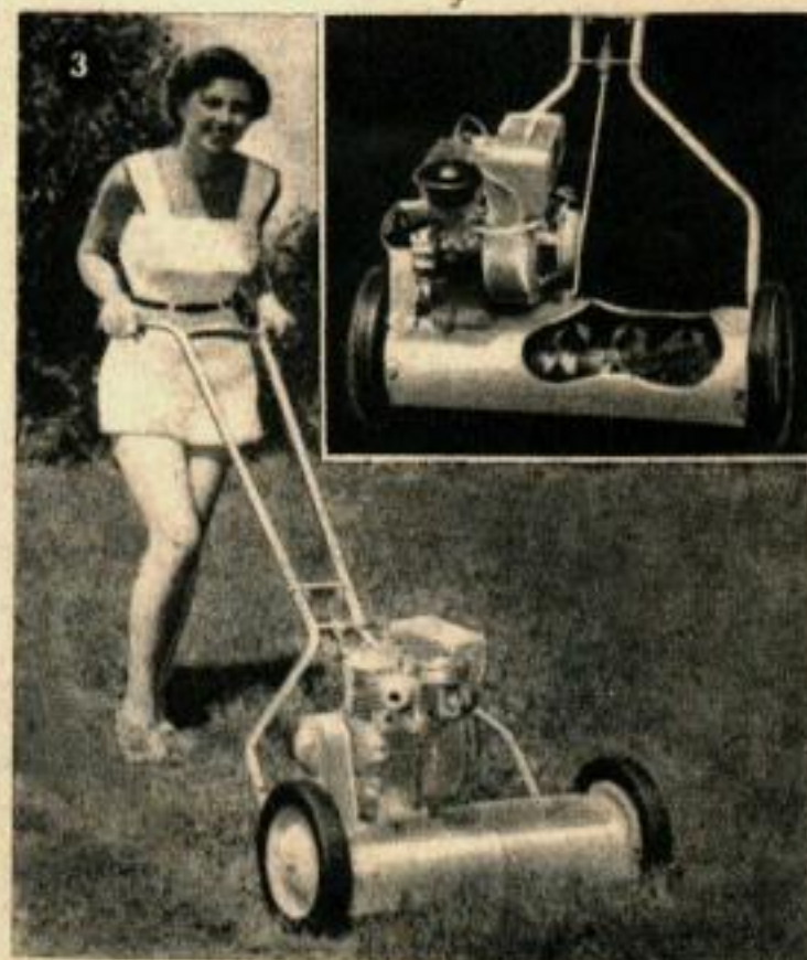
3. Cette tondeuse qui combine les avantages des machines rotatives et des machines à rouleaux est équipée de lames multiples débordant les unes sur les autres qui tournent à 5 000 tours-minute. Chaque tige est coupée par un coup porté de haut en bas. L'herbe est broyée en un fin hachis. Le couvercle arrête les projections de branches ou de pierres.
