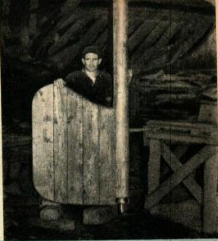
Le gouvernail en chêne blanc est monté sur un palier en bronze qui se trouve au pied de son arbre de 15 cm de diamètre. Le gouvernail est fixé sur l'arbre par des broches horizontales.
