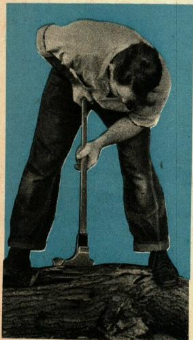
Ci-dessus: la coque prête à recevoir son recouvrement en planches. Les poteaux du bastingage sont montés juste au-dessus de la ligne de pontage. Ci-dessous: Carr utilise une herminette pour tailler une genouillère en chêne.
