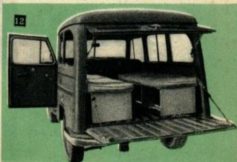
11 Ci-dessus, le plateau de couchette est fixé à l'avant par des consoles métalliques fixées sur le coffre. Il est supporté par une pièce de bois à hauteur du garde-boue arrière et repose à l'arrière sur un support à charnières. Ce dernier est fixé sur les lattes du plancher par une targe. À droite, des matelas de repos pour lits de repos en plein air font des matelas confortables et légers.
