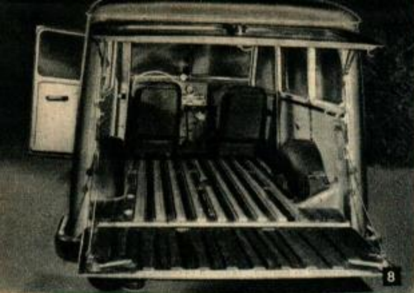
8 L'un des étroits sièges arrière est transformé en siège de chauffeur pour donner plus de liberté de mouvement à l'intérieur de la voiture. Ceci est appréciable pendant la marche ou quand il pleut dehors.
