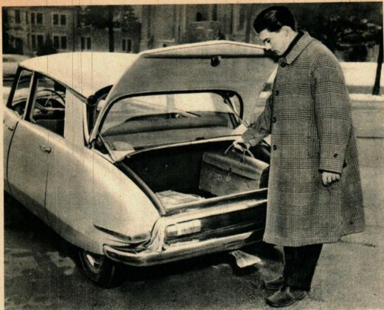
Sans aucune roue de secours et aucun pont arrière pour l'encombrer, la malle arrière est d'une profondeur étonnante. Remarquer la forme inusitée du couvercle.
