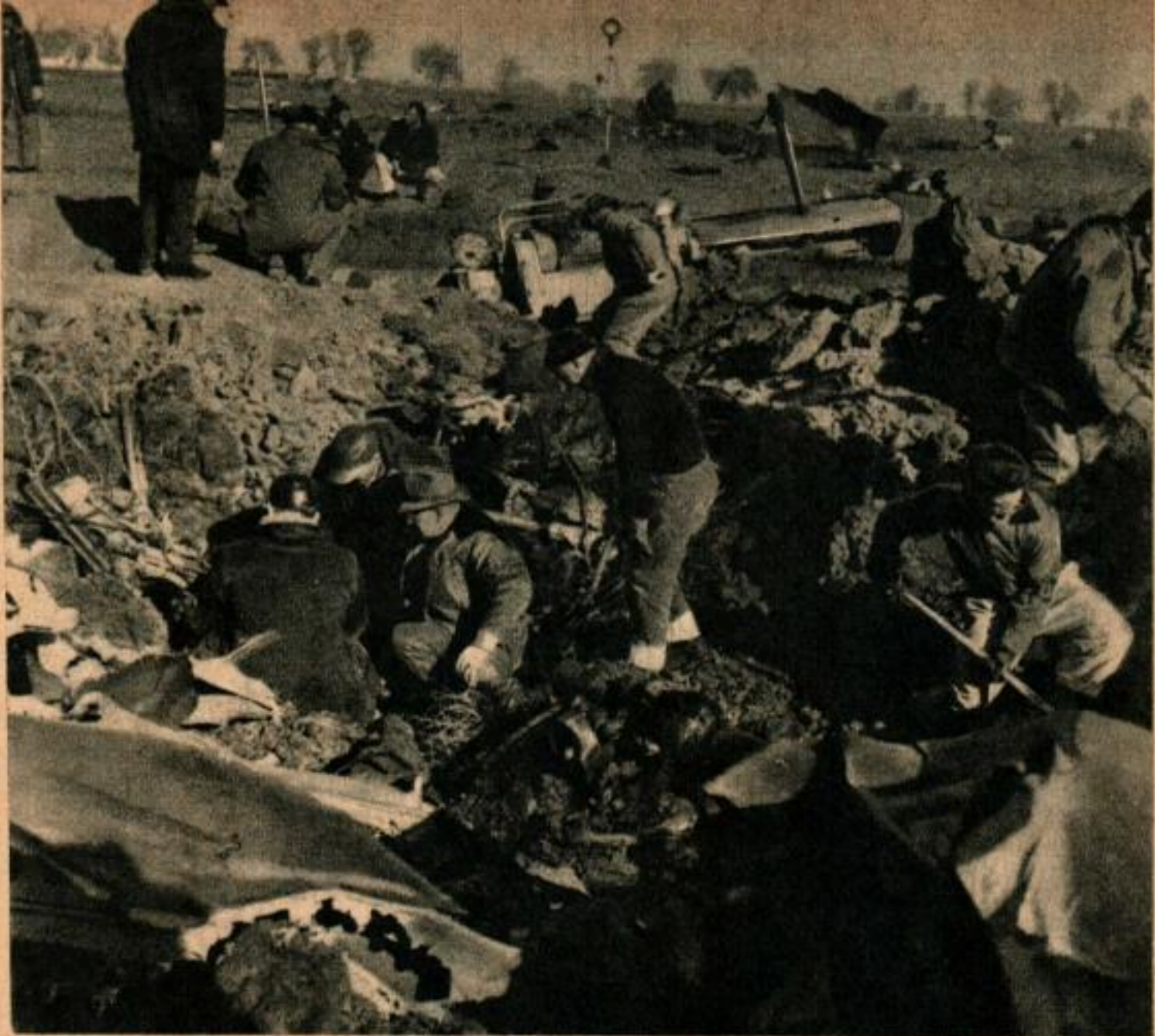
L'équipe des moteurs-et-hélices au travail dans un entonnoir où se trouvent deux moteurs. Un bulldozer dut être employé pour les dégager de la terre qui les recouvrait.
