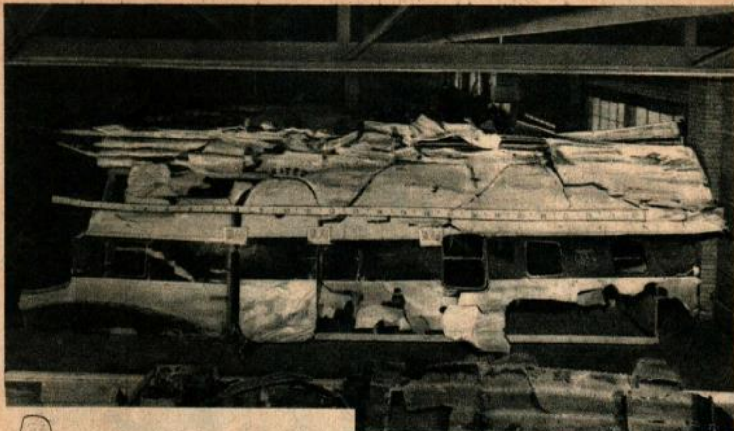
Ainsi qu'un puzzle géant, les pièces du «liner» sont assemblées à nouveau pour obtenir la confirmation des théories des investigateurs. Ci-dessus: la section du fuselage comprenant la soute à bagages n° 4.
