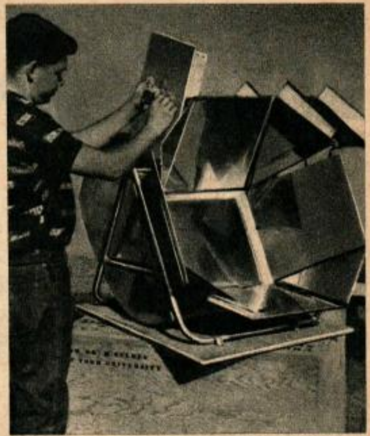
Fourneau solaire comportant une cloison vitrée qui est pointée vers le soleil. Les panneaux latéraux en aluminium concentrent la chaleur captée.
