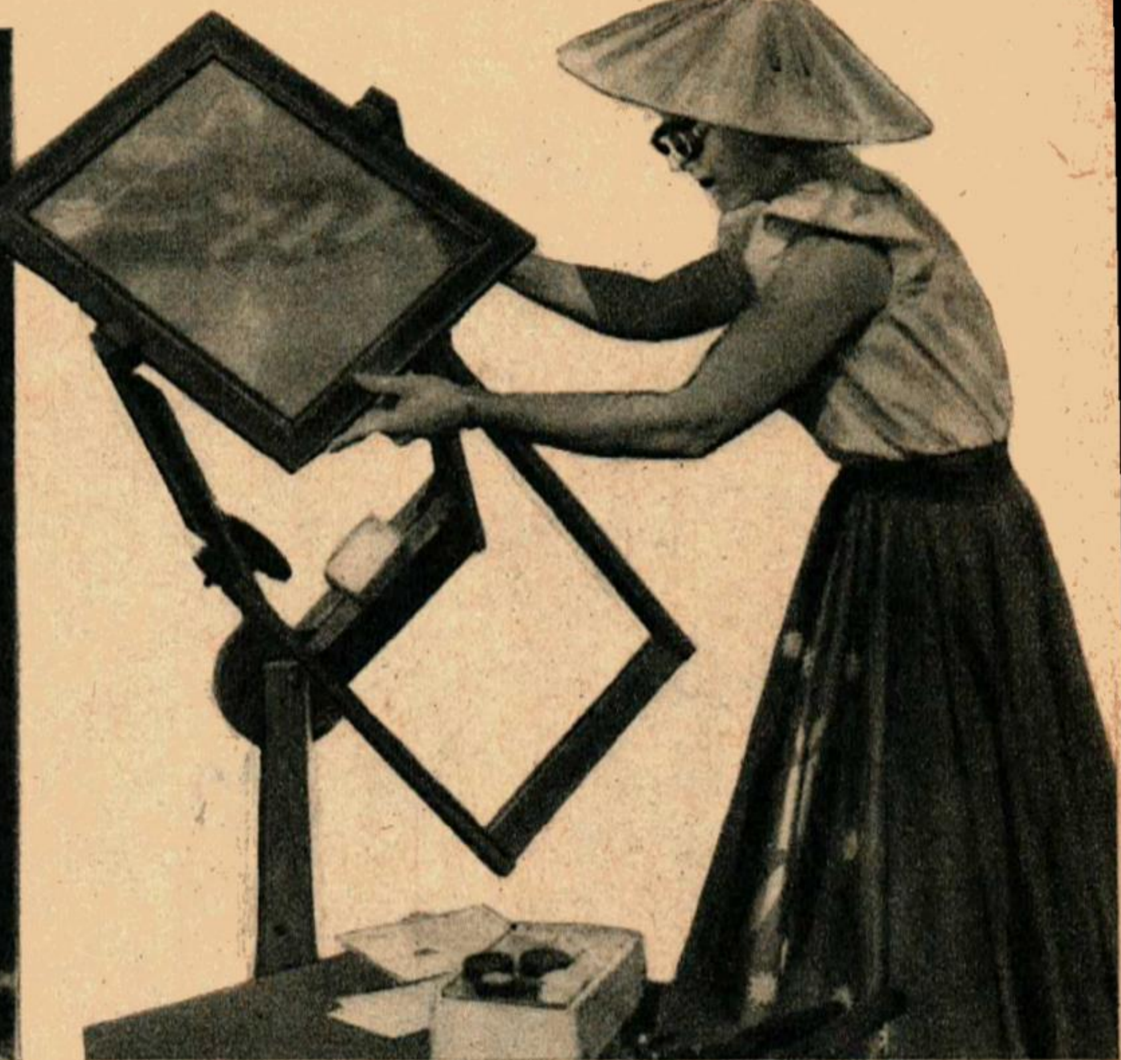
Ce four solaire dégageant des températures de l'ordre de 500° C modernise considérablement l'antique art de la poterie émaillée. Les rayons sont concentrés au foyer de l'appareil au moyen d'une lentille plate.
