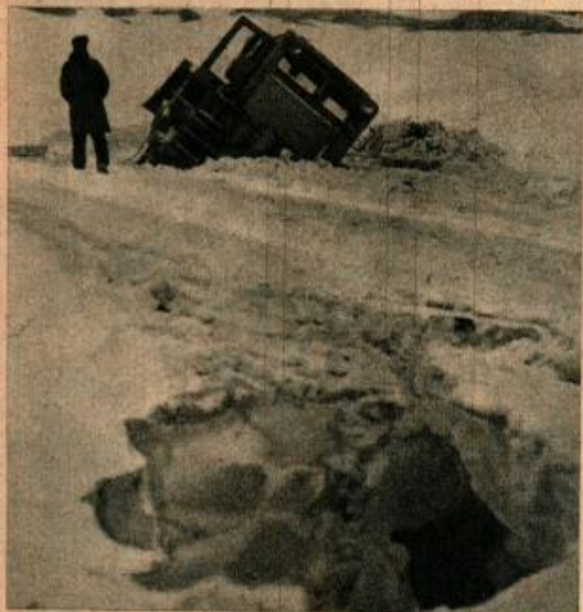
Cette crevasse recouverte de neige, près du Chenal Mac Murdo, prit au piège ce tracteur de 35 tonnes, qui ne put en être retiré à grand peine qu'avec des treuils.
