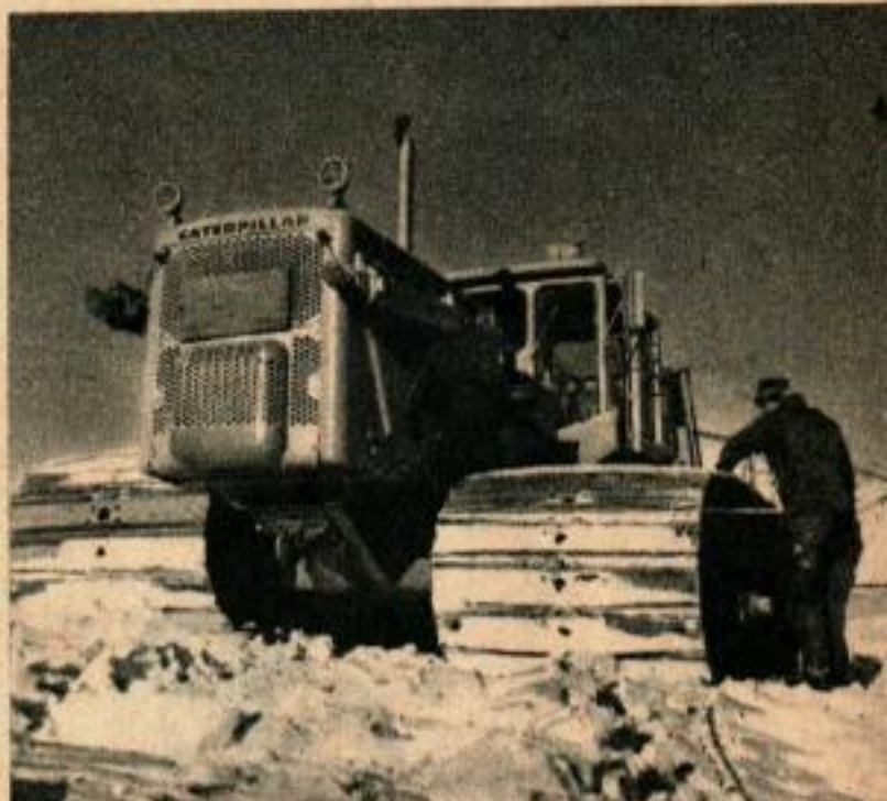
Même les tracteurs doivent porter des « chaussures à neige » dans l'Antarctique. Ce tracteur de remorquage de 35 tonnes est équipé de chenilles de 1,50 m de large.
