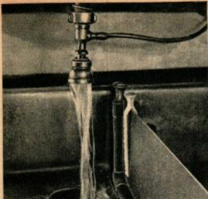
L'aspirateur se visse sur le robinet d'eau et se relie au panneau des robinets au moyen d'un tube en caoutchouc.
