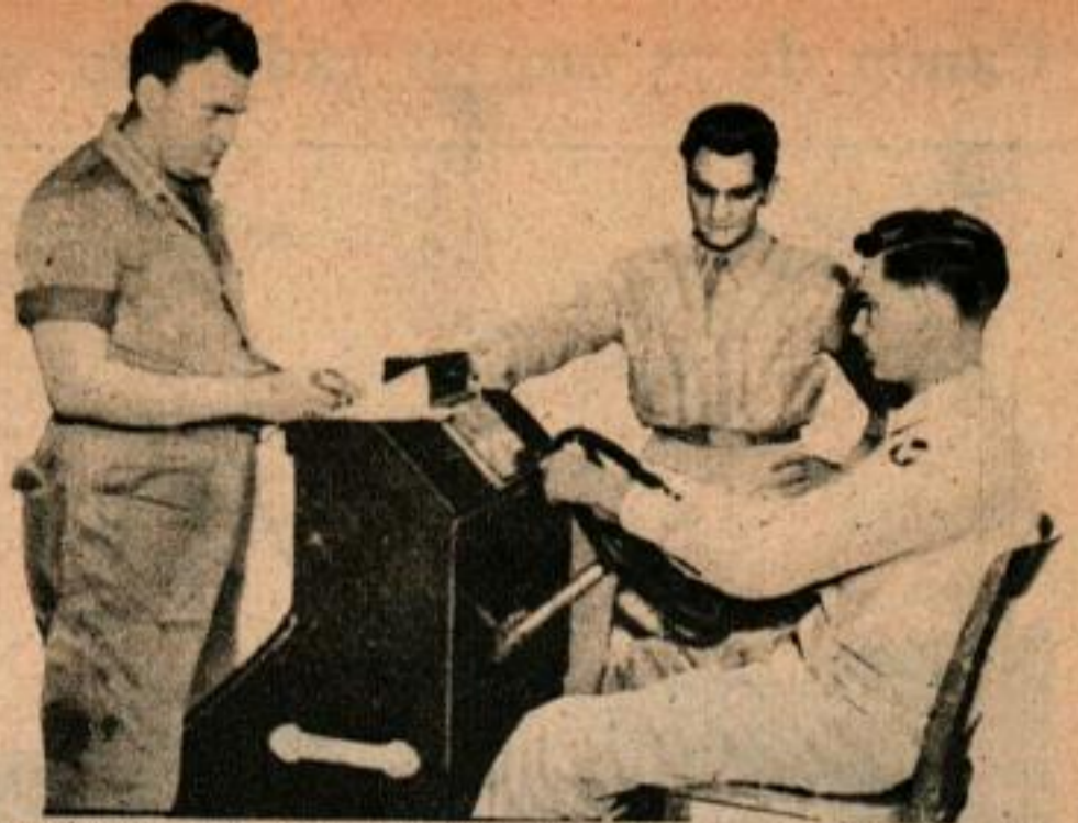
La réaction du pied des conducteurs est vérifiée au moyen d'une machine qui enregistre le temps nécessaire pour enlever le pied droit de l'accélérateur et le poser sur la pédale du frein.
