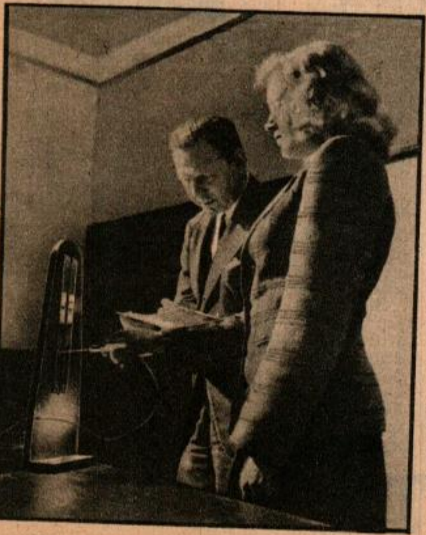
L'uniformité du volant est mesurée (à gauche) au moyen d'un stylet électrique. Si la pointe touche les côtés de la rainure verticale une lampe rouge s'allume. (À droite), l'aptitude à mesurer les distances est vérifiée au moyen de petites autos qu'il faut aligner.
