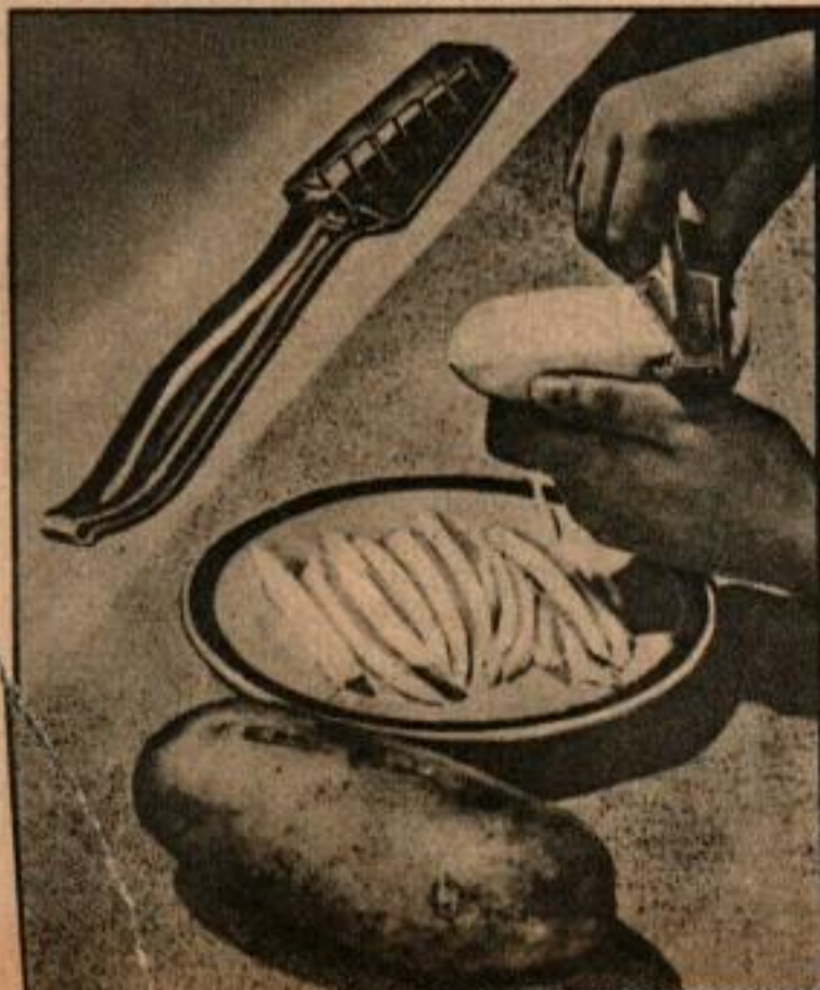
Appareil pour couper les pommes de terre quand on fait des frites. On coupe de quatre à cinq tranches de pommes de terre à la fois d'un seul mouvement de la main. Construit en aluminium il comprend une série de petites lames coupantes qui font le travail.
