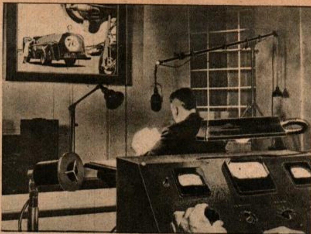
Un narrateur commente le film en regardant l'écran, sa voix s'inscrit sur le film. Un ingénieur du son, règle l'enregistrement sur le film.
