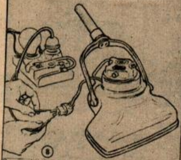
8 On emploie une lampe témoin pour chercher les ruptures dans l'induit ou l'inducteur
