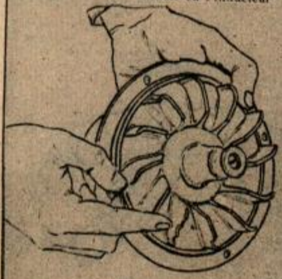
9 Des ailettes brisées sont la cause de vibrations et d'usure anormale des paliers du moteur
