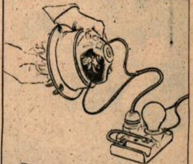
12 Tournez les ailettes doucement pour vous assurer s'il y a une rupture dans l'induit
