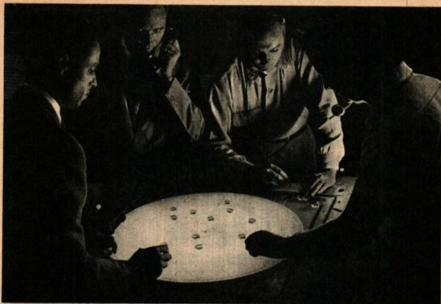
Dans ce dispositif expérimental, on projette l'image d'un radarscope sur une table en verre. Des contrôleurs déplacent des pions mobiles au fur et à mesure des déplacements des taches lumineuses.
