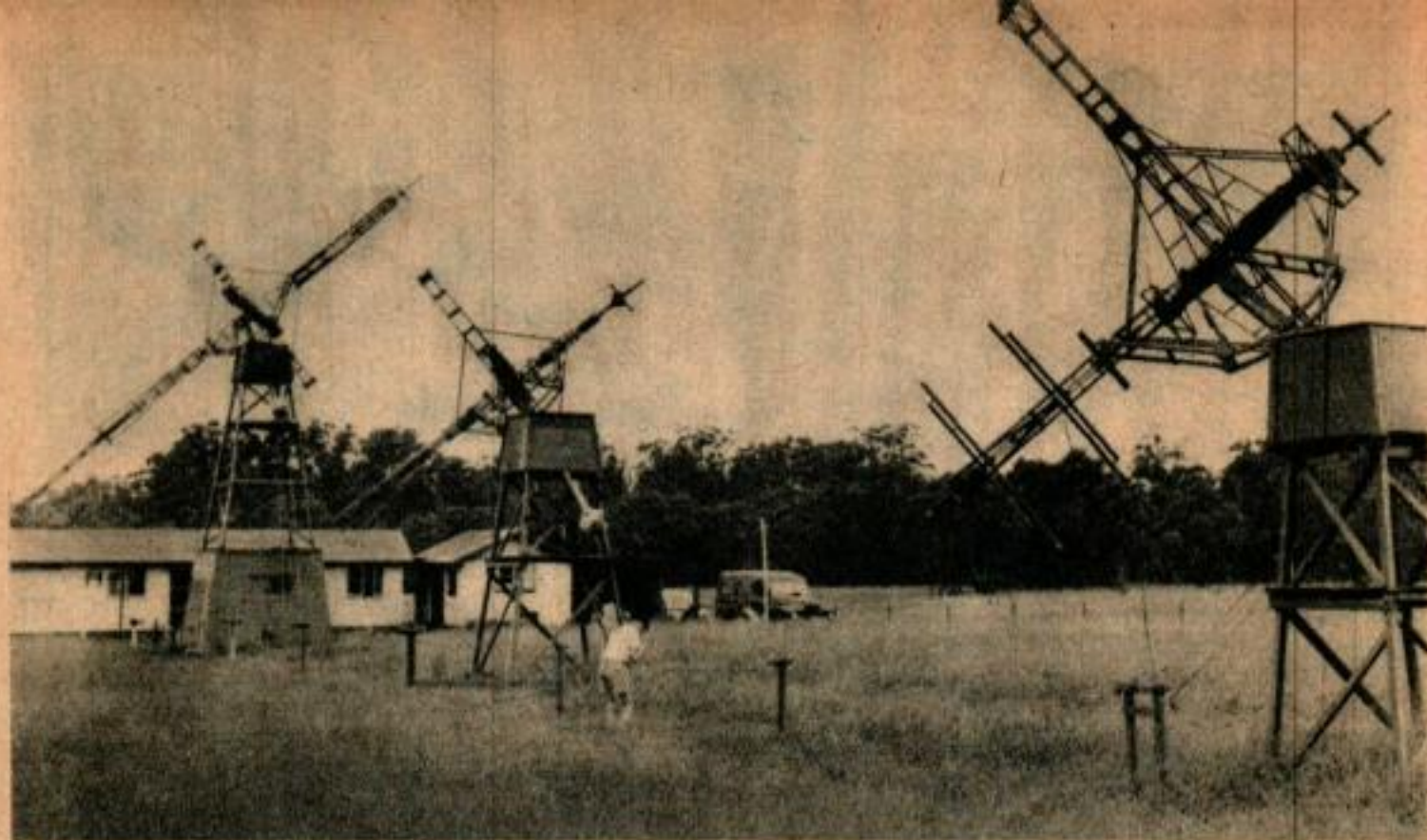
Des antennes rhomboédriques pivotent pour suivre la course du soleil et pour recueillir les variations brusques des ondes radio intenses émises par cet astre.
