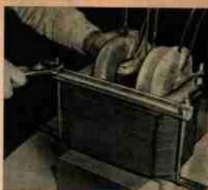
11. Le cadre de fixation du noyau est serré légèrement, puis les éléments laminés sont alligés et le cadre est serré à fond.
