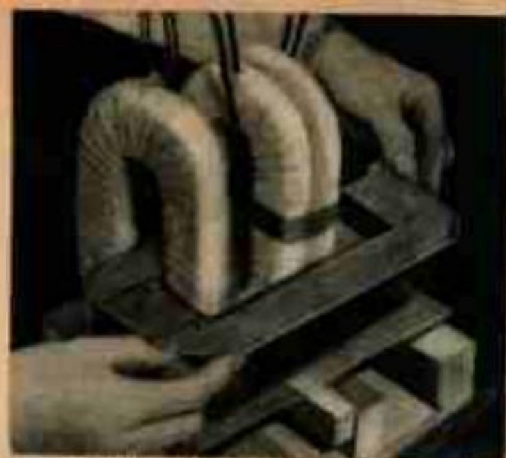
10. Les trois bobinages sont maintenus verticaux dans un montage pendant que les éléments laminés du noyau sont empilés autour d'eux.
