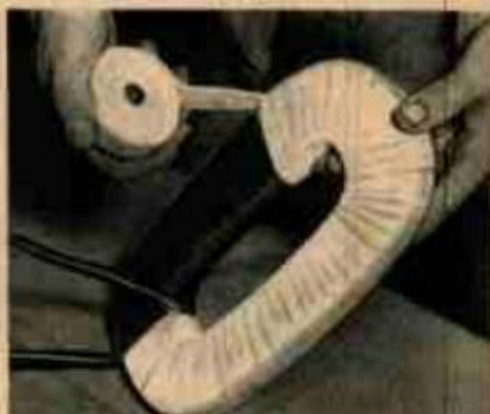
9. Les bobinages terminés sont recouverts de gomme laque ou de vernis isolant, puis enveloppés de ruban plastique.
