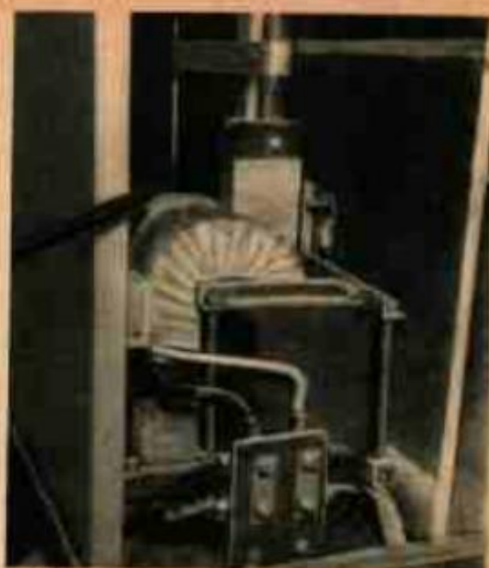
22. Les conducteurs sortant des bobines sont soudeés sur une plaque isolante pour faciliter leur connexion aux fils d'électrode et de masse.
