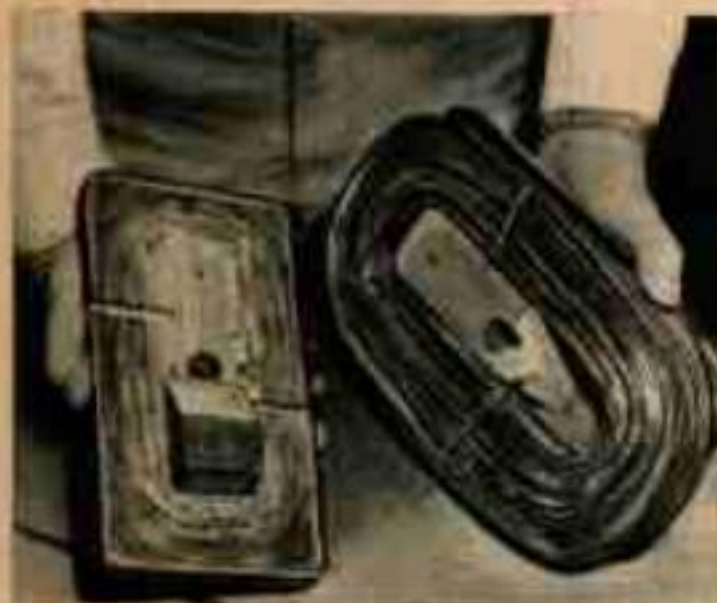
8. Les deux unités de montage sont assemblées avec un bouton, de sorte qu'elles peuvent être ouvertes pour permettre l'enlèvement du bobinage terminé.
