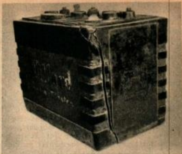
Une charge trop basse, jointe à une période de froid, a complètement ruiné cette batterie dont le gel a fait craquer le bac.
