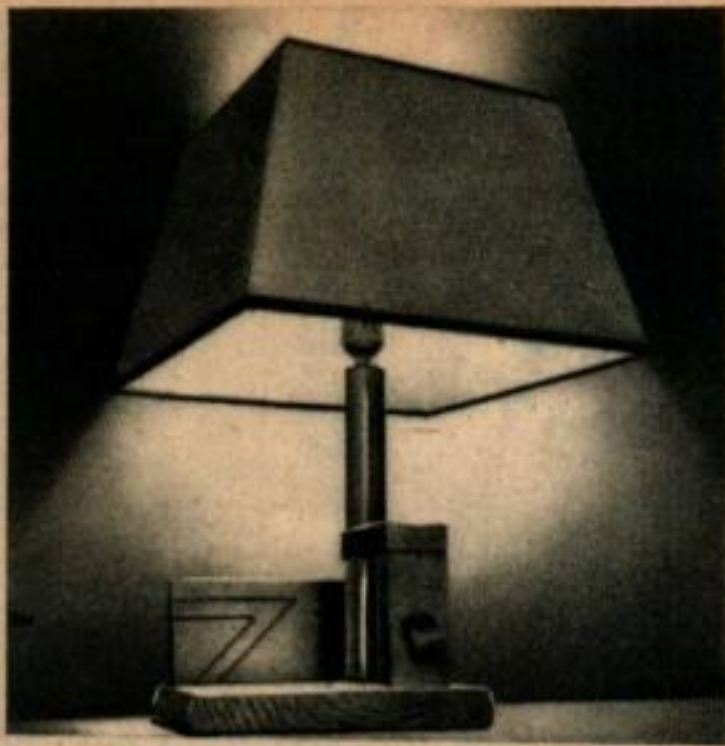
Le pied de cette lampe inédite est constitué par une seule baguette. La base de style moderne est faite de plusieurs chutes de planches poncées, teintes à la couleur désirée, puis vernies.
