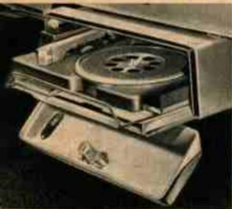
Ci-dessus, vous pouvez avoir n'importe quelle voiture du groupe Chrysler munie d'un phonographe pour disques de longue durée, monté sous le tableau de bord.
