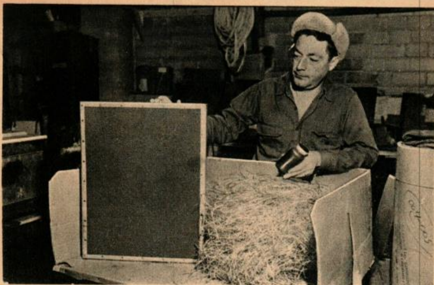
Norbert Ruff tient un élément catalyseur. Il est fait de fil métallique résistant à la chaleur et recouvert de dérivés du platine et du palladium livrés en bouteilles.
