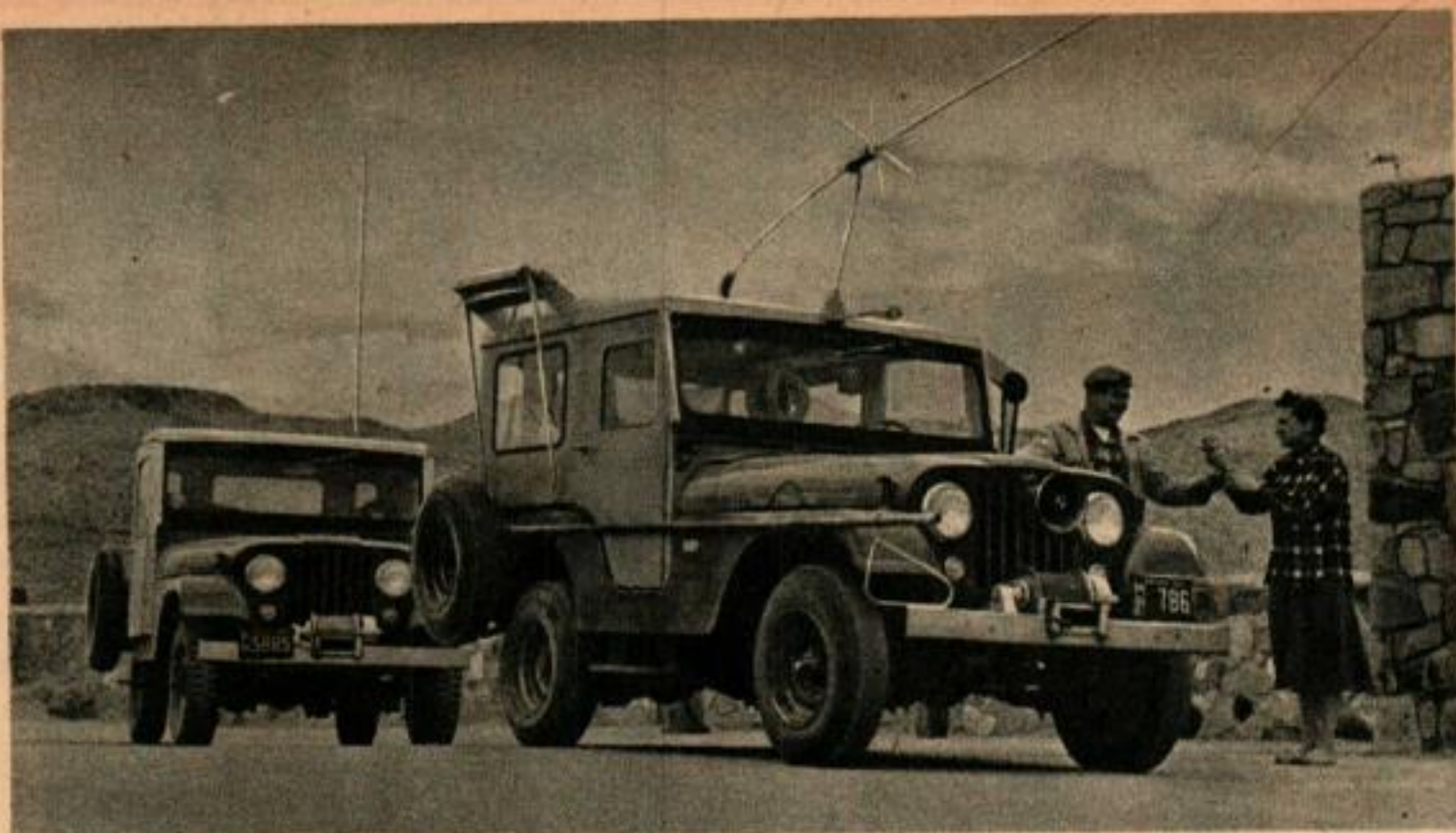
Départ des prospecteurs pour le désert aux premières lueurs de l'aube. Le dispositif placé au-dessus de la cabine de la Jeep de tête permet de détecter la radioactivité.
