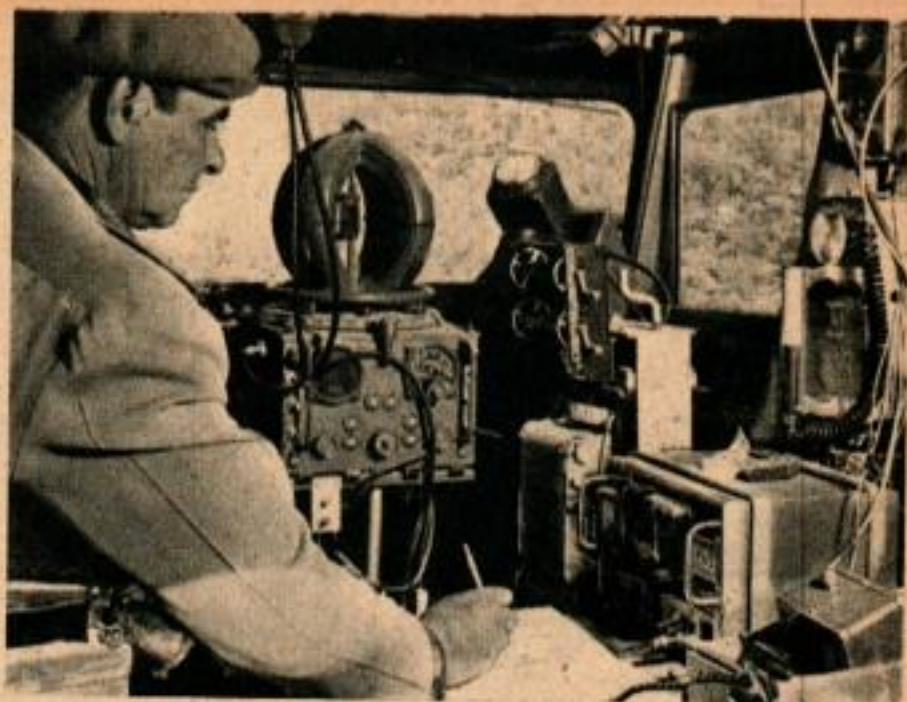
L'intérieur de la Jeep est bourré d'instruments. Près du conducteur, un graphique mobile enregistre de façon continue la radioactivité. Ci-dessous Campbell étudie au fluoroscope un échantillon de roche. La Jeep transporte également un microscope et un nécessaire d'analyses chimiques.
