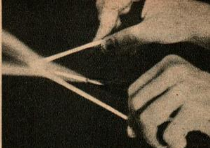
Une baguette de saphir, chauffée à 1700 C., au moyen d'un chalumeau, est pliée à la main.
