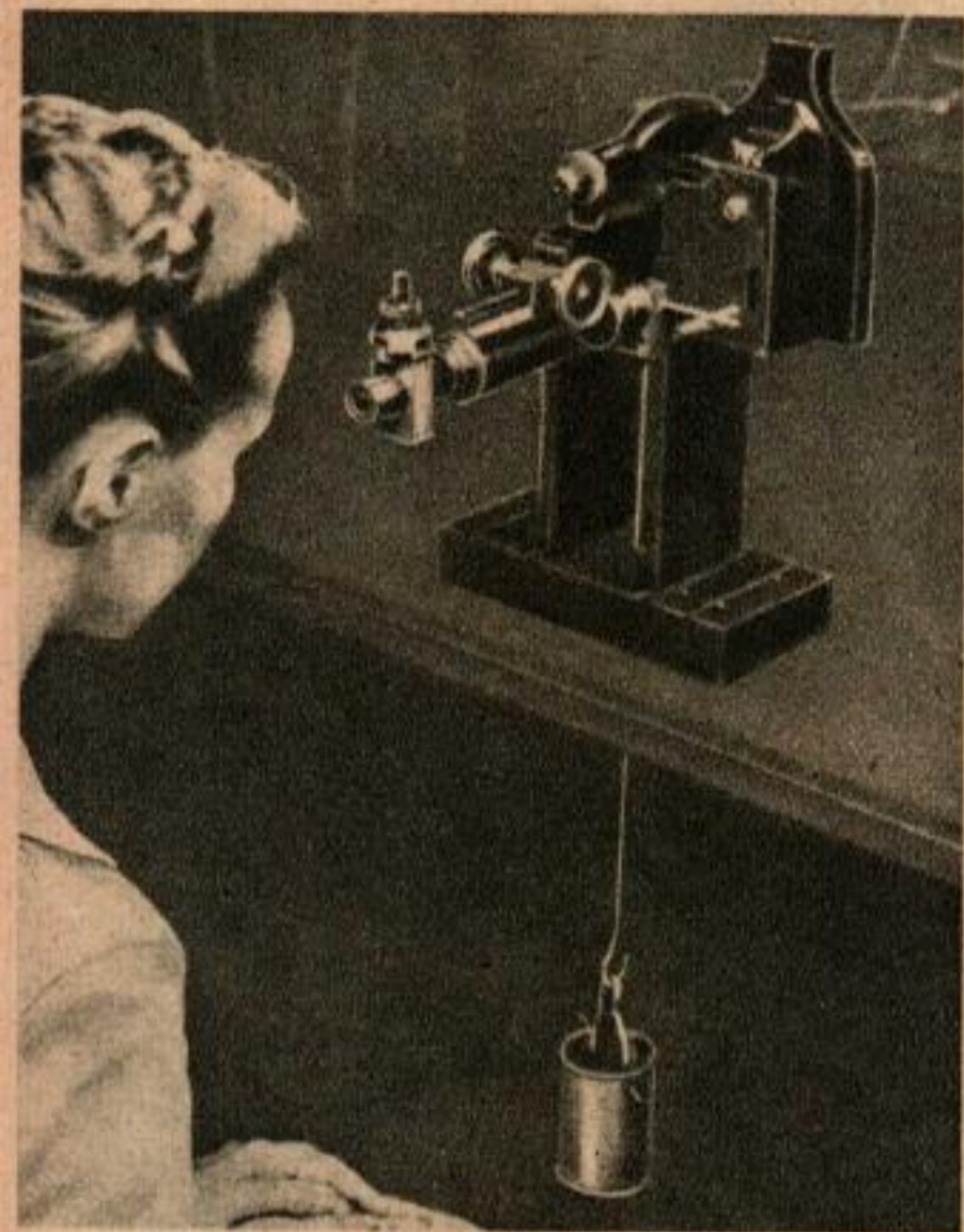
Un instrument d'essai vérifie la résistance à la traction d'une baguette de saphir.
