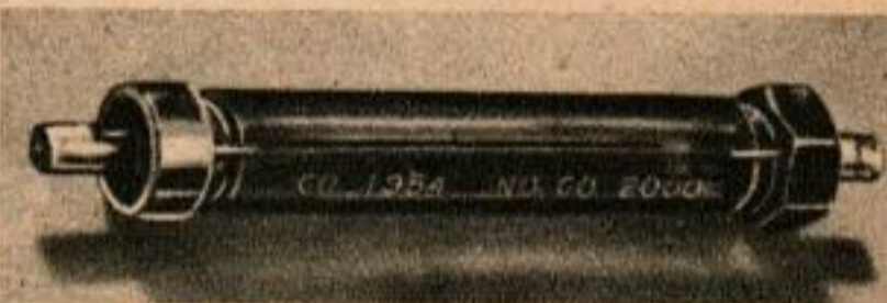
Les pierres sont fabriquées sous forme de baguettes qui sont ensuite découpées en disques.
