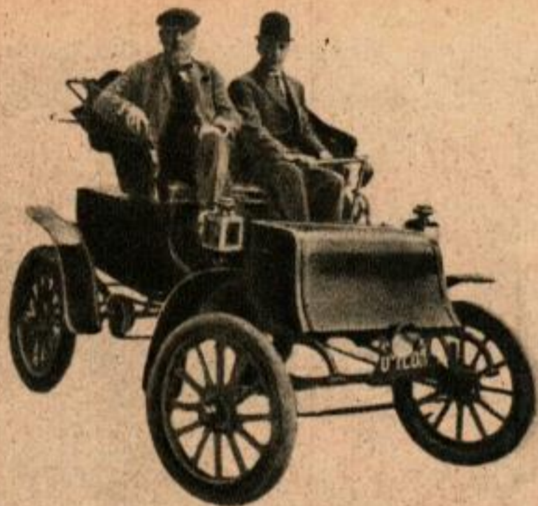
L'accumulateur alcalin d'Edison utilisé sur les voitures électriques est aujourd'hui employé dans les lampes de sécurité des mineurs et assure la traction des wagonnets au fond des mines.
