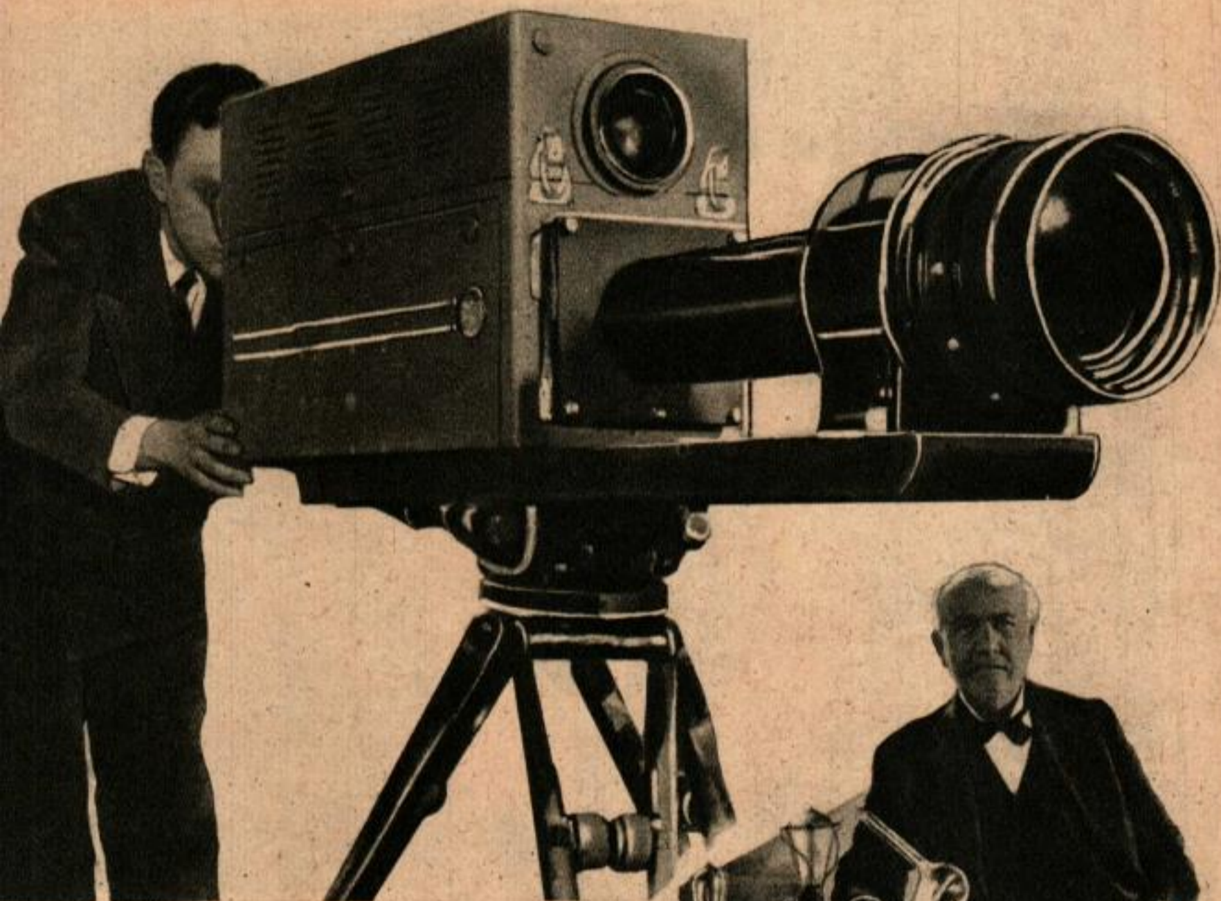
Cet appareil de prise de vues de télévision, appartenant à la N. B. C., possède une distance focale de 100 cm., la plus grande utilisée à ce jour. La télévision et d'autres applications électroniques doivent le jour à la découverte de „l'Effet Edison", que le savant fit en étudiant les lampes à filament extérieur.
