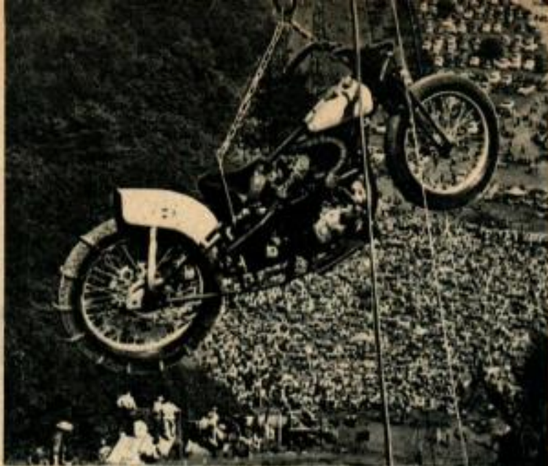
Les concurrents doivent retourner à pied au bas de la pente, mais leurs engins sont descendus au moyen d'un téléski fonctionnant à l'envers. Remarquez les lourdes chaînes de la roue arrière.
