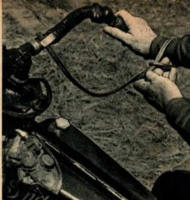
Le règlement de sécurité impose un système coupant le moteur si le conducteur est projeté hors de sa machine. Lorsque la courroie est arrachée de l'attache située sur le guidon, le contact est coupé.
