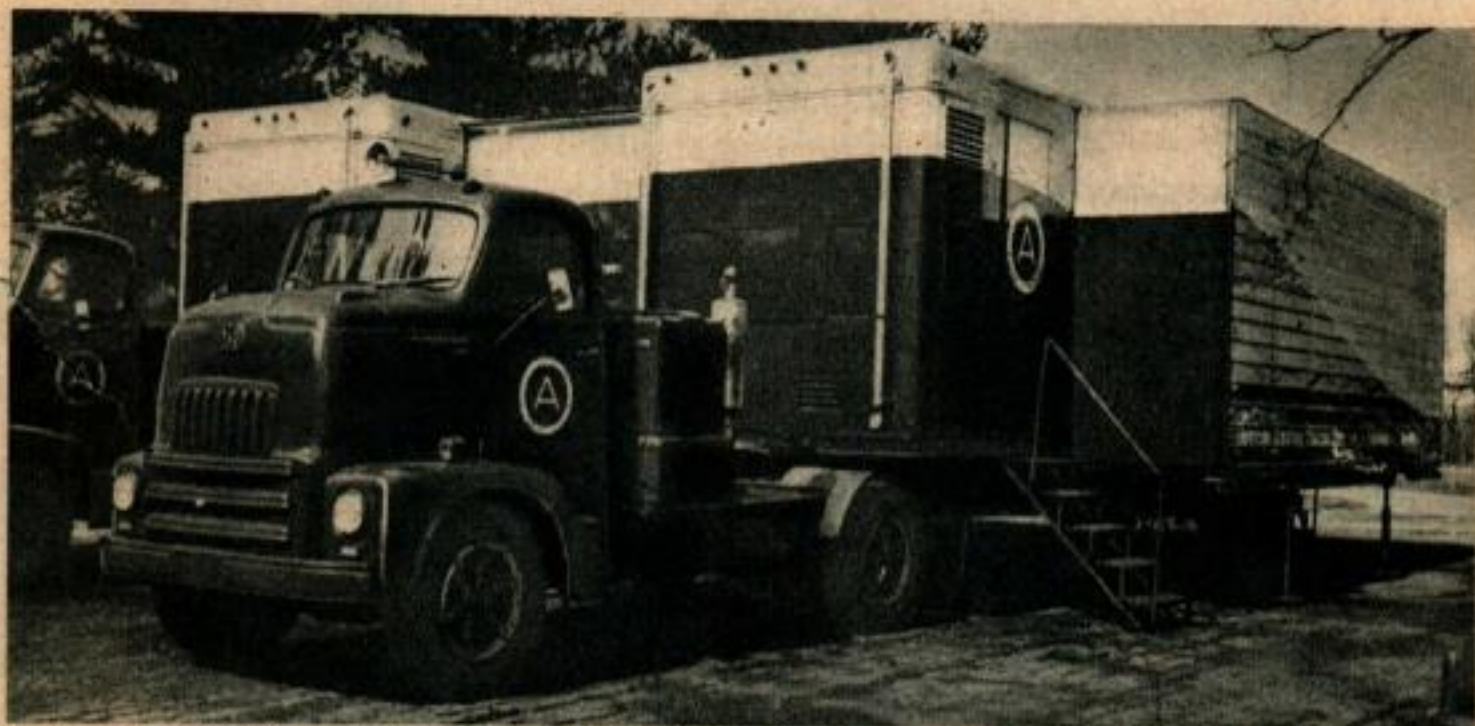
En garant deux camions poids lourds l'un à côté de l'autre, chacun étant doté de parois dépliantes, et en les accouplant de la manière montrée ci-dessous, cette société transporte son propre auditorium mobile qui lui permet de mettre des sièges à la disposition de cent personnes pour les réunions.
