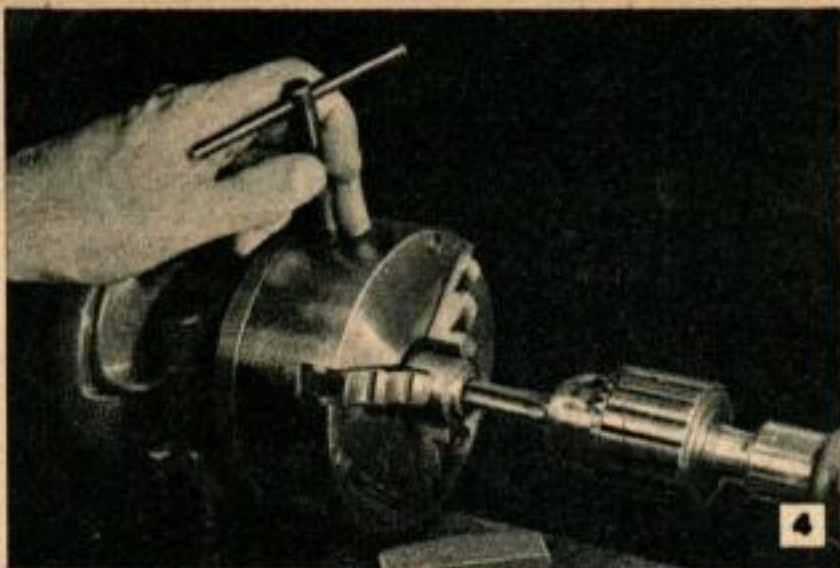
Le taraudage du socle se fait au tour ou à la perceuse. Employer à cet effet le taraud cylindrique pour pouvoir atteindre le fond du trou.
