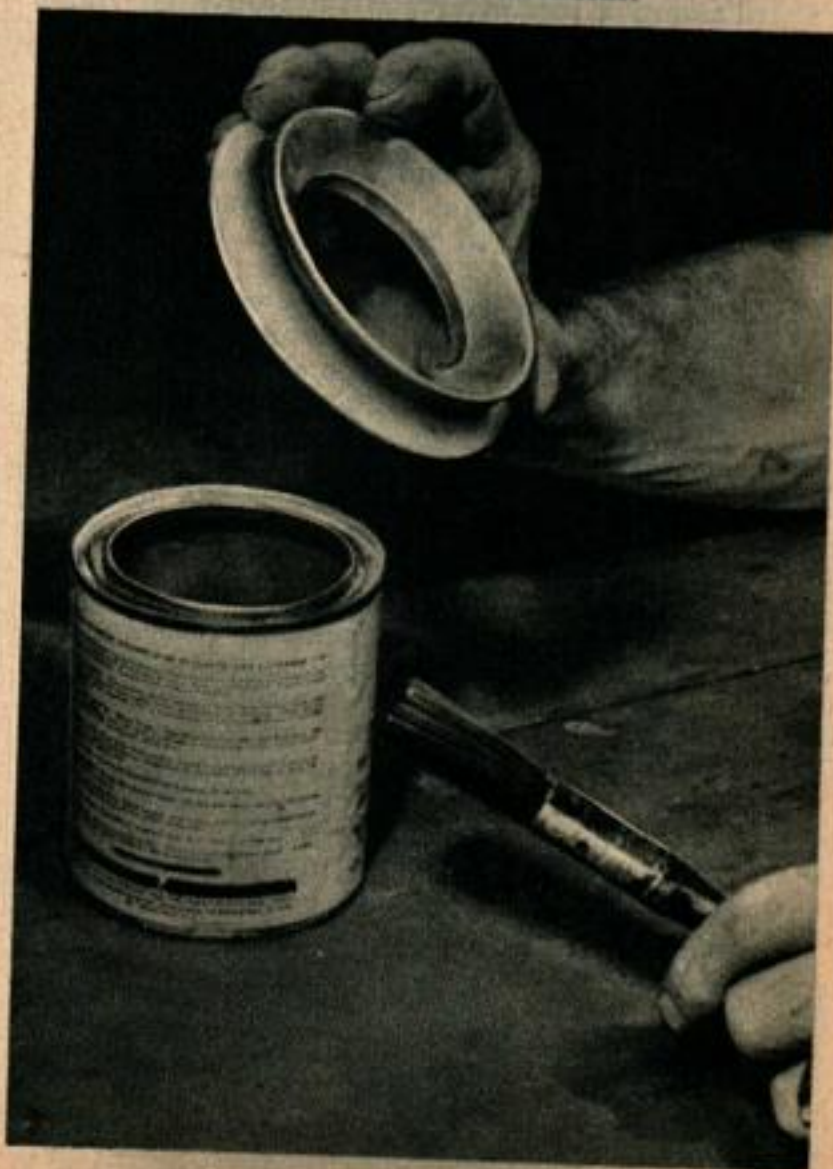
Ce dessus de boîte de peinture qui recueille les gouttes et garde les bords propres pour refermer la boîte est l'une de ses récentes inventions.
