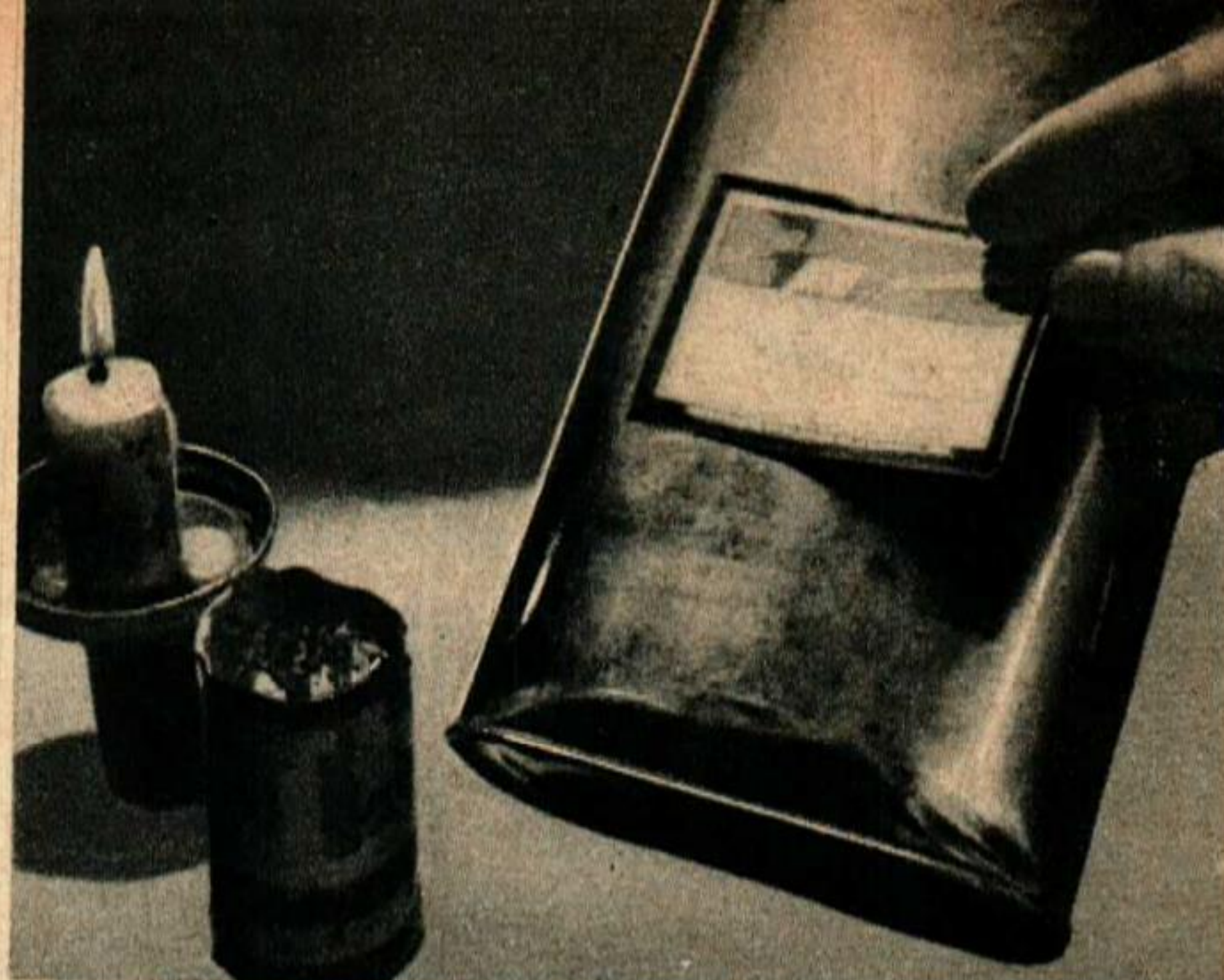
Les étiquettes gommées tiennent mal sur le métal poli. Les faire adhérer au moyen de colle à disques abrasifs chauffée légèrement.
