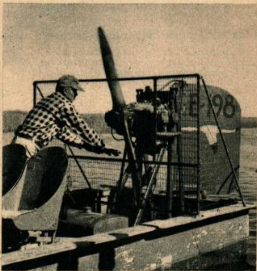
L'opérateur lance l'hélice pour faire démarrer le moteur. Un écran protecteur évite les accidents. Les hydroglisseurs sont actionnés le plus souvent par des moteurs d'avions mis au rebut.
