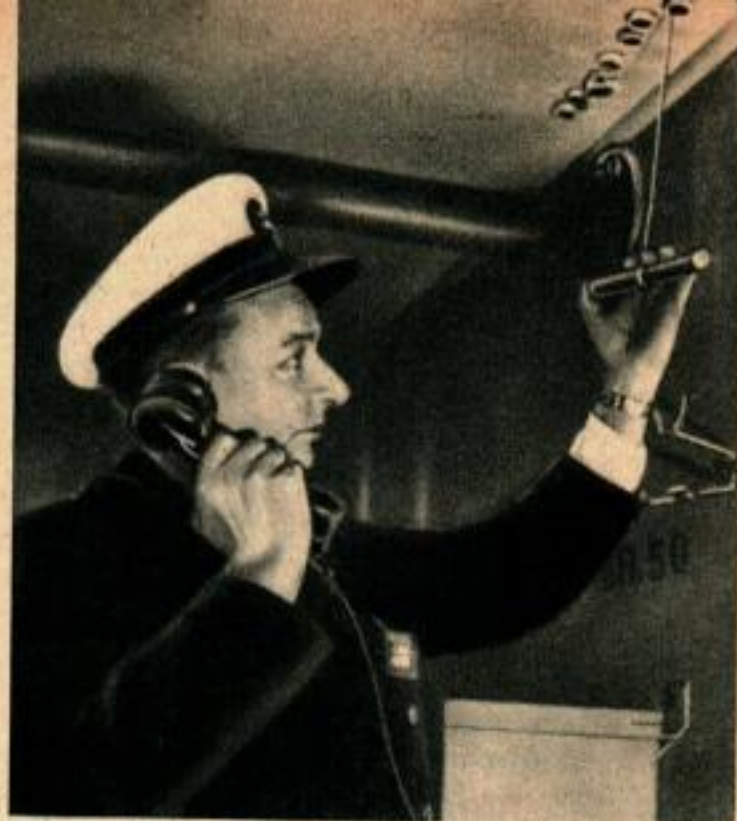
L'échantillon radioactif enfermé sous enveloppement de plomb est attaché au bout d'un câble. La radioactivité est libérée lorsque l'instructeur tire le câble et expose l'échantillon durant quelques instants. Quand la décontamination est engagée, les échantillons réintègrent leur enveloppe protectrice de plomb.
