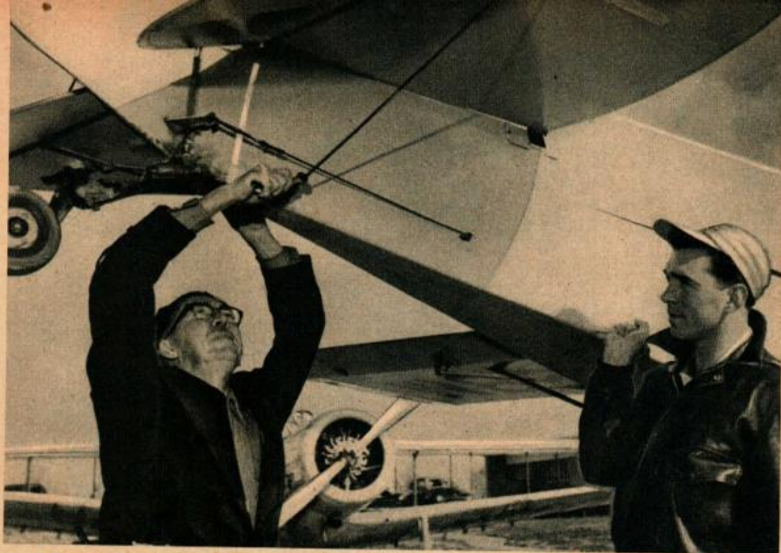
Autrefois pilote d'avion au cours des meetings campagnards, Hamlin trouve enfantin de remettre en état l'ajustage de l'empennage de queue d'un avion endommagé au cours d'un atterrissage un peu trop violent.
