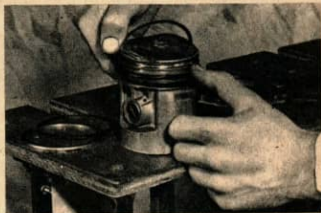
Au milieu, pose du segment racler chromé. Ci-dessous, à gauche, ensemble d'un jeu de segments. À droite, microphotographie d'une coupe de segments montrant la couche de chrome dur.
