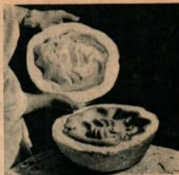
Après séparation des deux moitiés, le moule est ouvert et l'objet enlevé.
