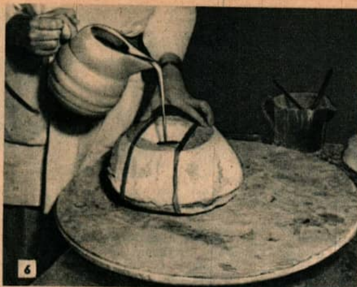
A gauche, les deux moitiés du moule sont assemblées et la bouillie est versée à l'intérieur de la cavité. Ci-dessus, après le dégorge et la mise des couleurs, la pièce est plongée dans l'émail.
