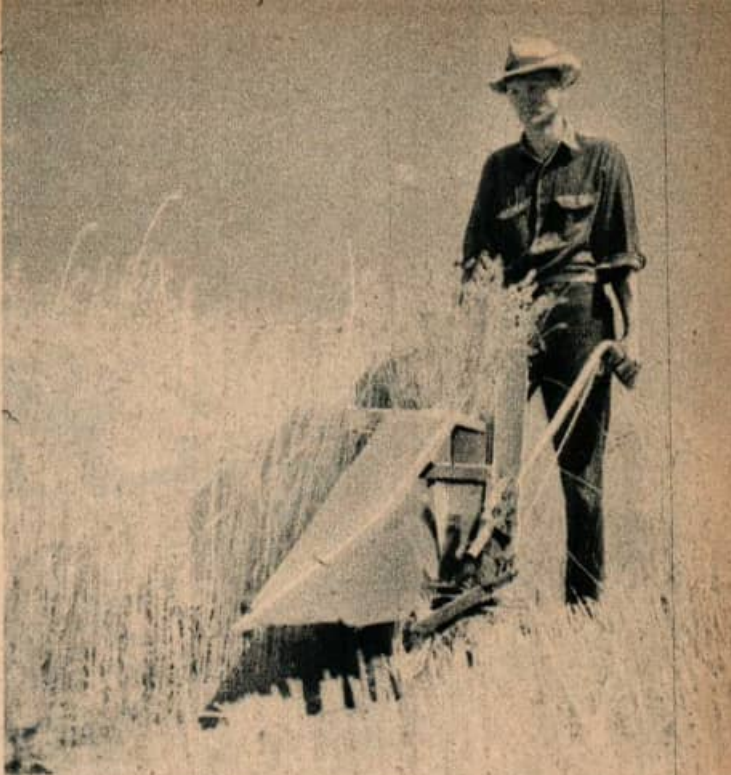
Ci-dessus, un cultivateur participant à des recherches, coupe une rangée de blé expérimental à la fois avec cette petite moissonneuse qui évite de mélanger cette variété avec les qualités voisines. Ci-dessous une autre machine miniature pour stations d'essais est une batteuse essayée sur une récolte de pois.
