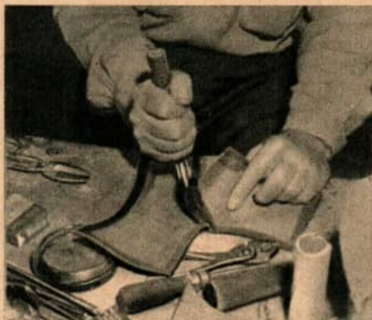
Deuxième phase : les bords de jointage sont effleurés et enduits de dissolvant, puis vulcanisés avec de minces bandes de caoutchouc brut.
